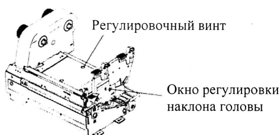
а. Наклон печатающей головы для печати этикеток
